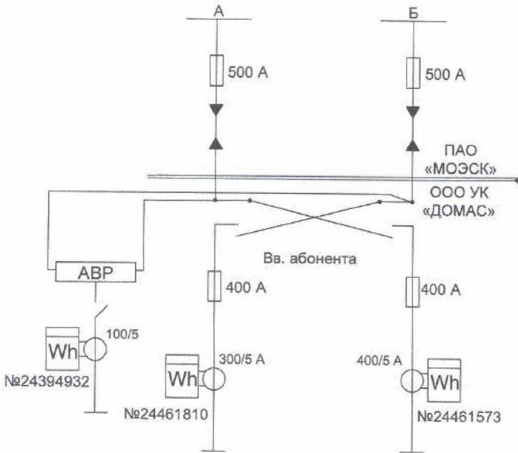
**Примечание:** в схеме указываются места установки и номера приборов учета, параметры измерительных трансформаторов тока и напряжения, границы балансовой принадлежности (красный цвет) и эксплуатационной ответственности (синий цвет), границы с субабонентами/транзитными потребителями (зеленый цвет), длина и марка питающих кабелей (проводов).
